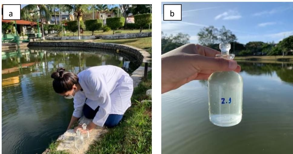
**Figura 2.** Coleta de água na lagoa de Itapetinga (a); frasco com amostra para análise laboratorial (b).
